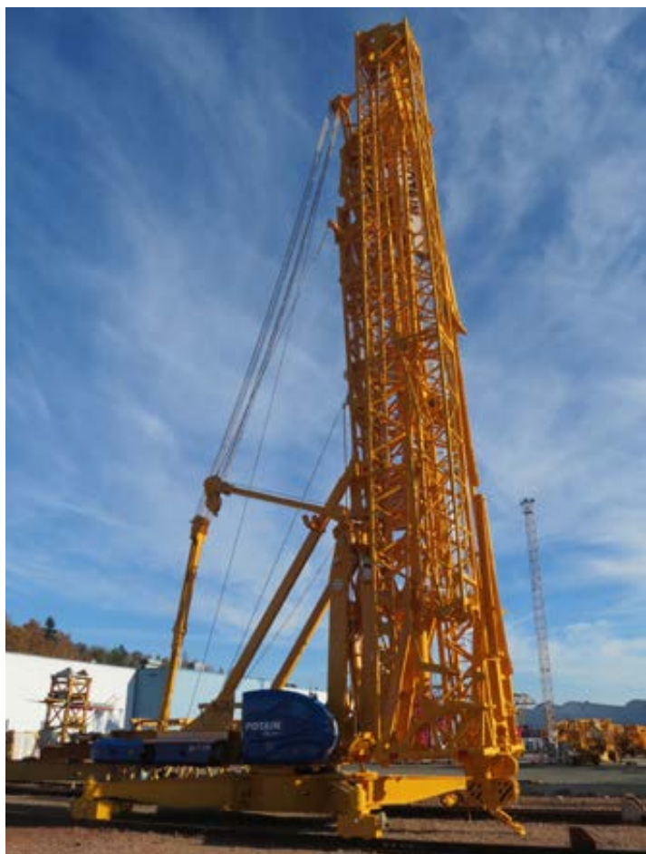
▼ Basculamento idraulico della torre
