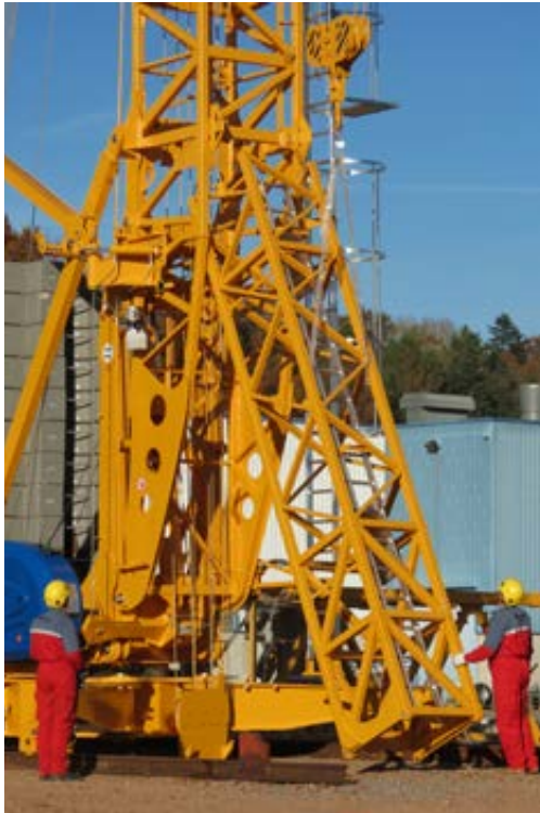
^ Telescopaggio tramite inserimento di elementi di prolunga
