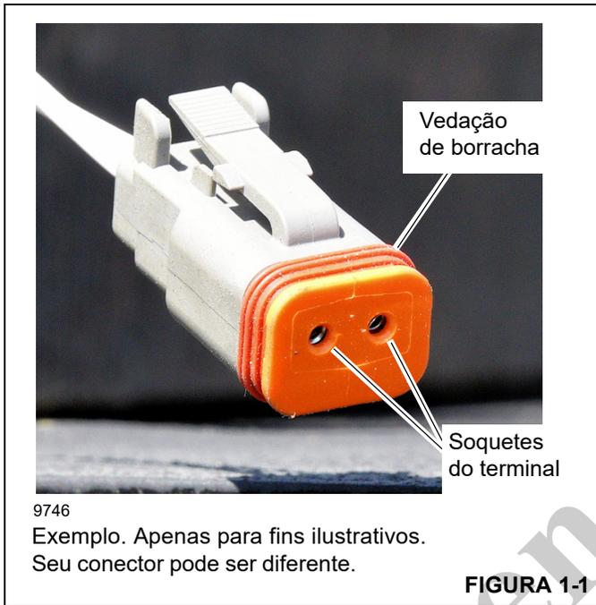
4. Use um pano limpo para remover o excesso de graxa da superfície do conector e limpe a graxa nos soquetes do terminal (Figura 1-1).
