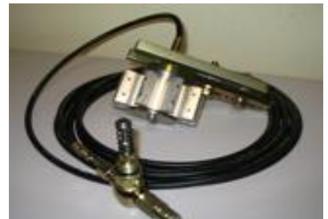
Beispiel eines Kits für die Schmierung der Verzahnung Modul 10
