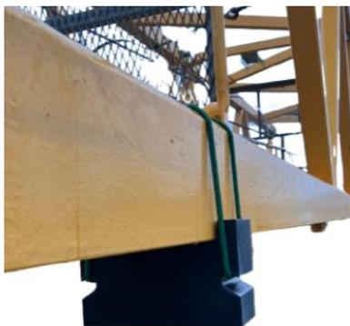
La fascia elastica mantiene lo spessore in posizione durante la movimentazione dell' elemento.
