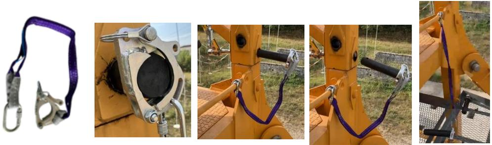
Este Sistema bloqueável Evita o risco de queda das cavilhas durante a desmontagem da grua
