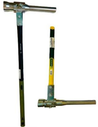
Este sistema evita o risco de esmagamento das mãos e vibração quando as cavilhas são difíceis de remover.
