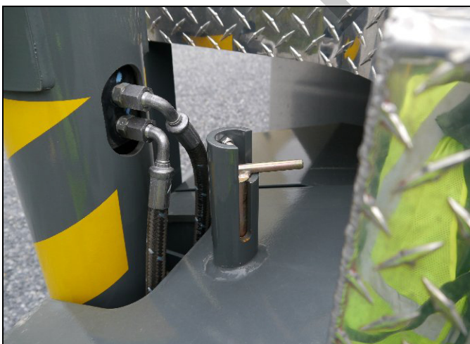
Pasador de extensión media en posición de almacenamiento 9329-1 FIGURA 4-7
