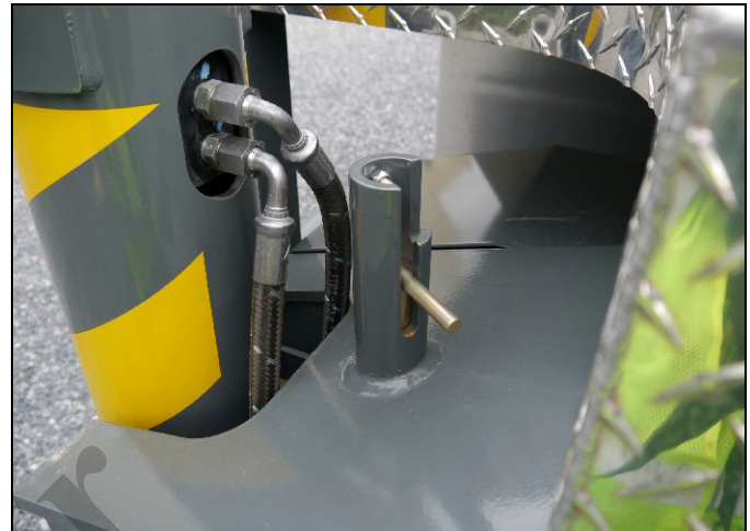
Pasador de extensión media en posición bloqueada 9329-2 FIGURA 4-8
