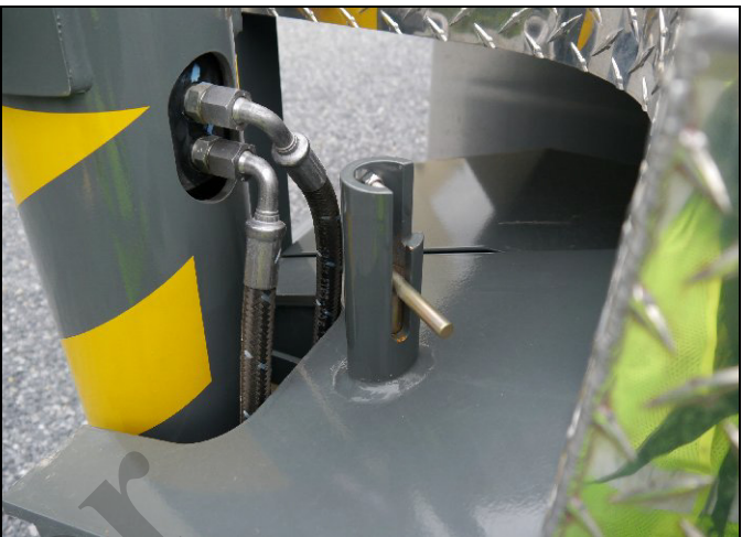
Pasador de extensión media en posición bloqueada 9329-2 FIGURA 4-10
