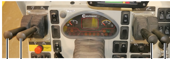
Válvulas de controle remoto (na cabine do operador)
