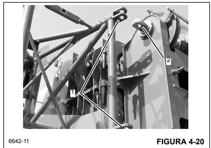
11. Saque los pasadores (1, Figura 4-21) que están almacenados en la extensión e instálelos en los orificios (en el lado derecho de la punta de la pluma) y fíjelos con pinzas de retención (2).
