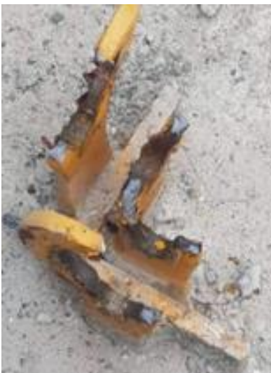
Pata de empotramiento
