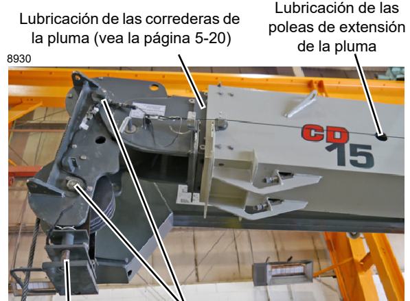
8930 Lubricación de las correderas de la pluma (vea la página 5-20) Lubricación de las poleas de extensión de la pluma Lubricación de la polea de la cabeza de la pluma Lubricación del pasador guía de la escuadra de prevención del contacto entre bloques
