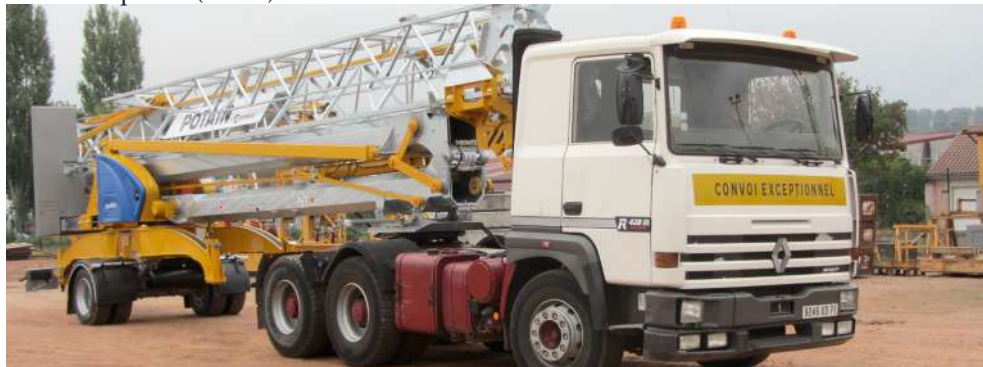
Transporte por grua totalmente lastrado
