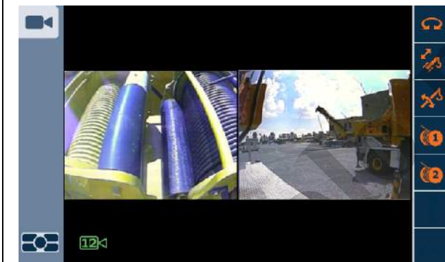
9219 Ejemplo: Pantallas de vista 1 y 2 de cámara activas
