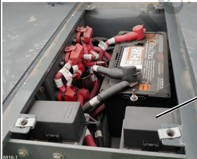
Ubicación del bloque de fusibles en el compartimiento de batería/relés, solo motor T4F
