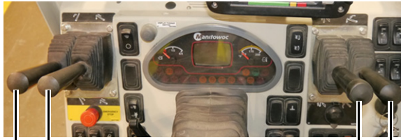
Válvulas de control remoto (en cabina del operador)
