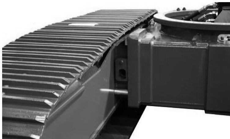
Fig. 108 Tren de rodaje con los pernos retirados (A)
