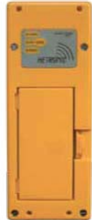
Fig. 3 Cargador HETRONIC con batería de 9.6 V
