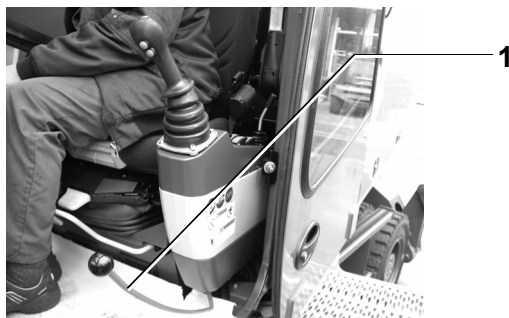
Fig. 62 Palanca de seguridad liberada (empujada hacia adelante)
