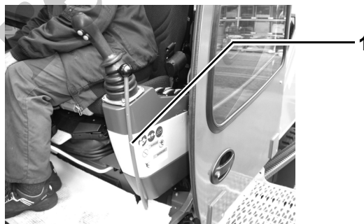
Fig. 61 Palanca de seguridad activada (tirada hacia atrás)
