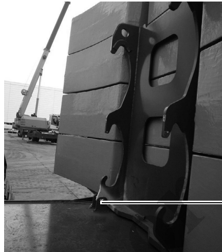
Fig. 119 Argolla (2) para el perno de bloqueo
