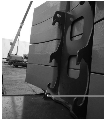
Fig. 130 Olhal (2) do parafuso de trava
