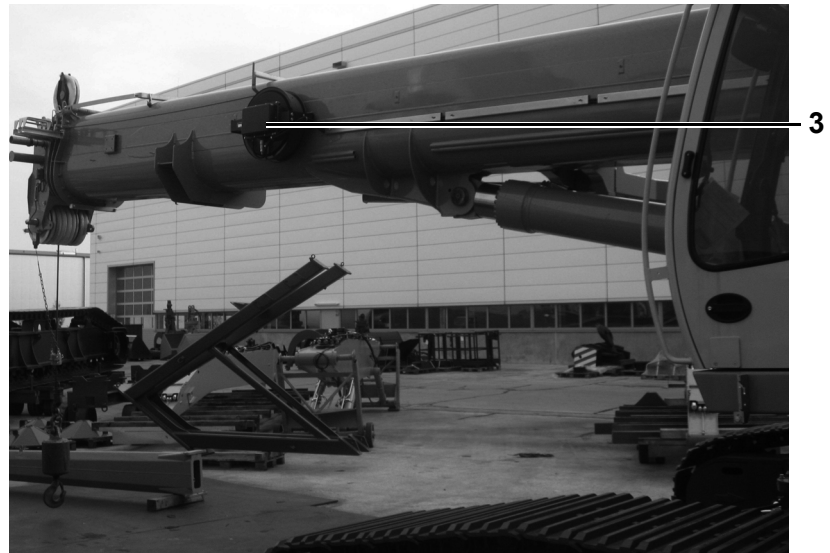
Fig. 85 Transmissor de comprimento e ângulo/tambor do cabo de mola (3)
