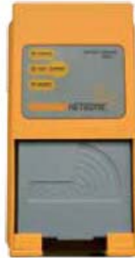
Imagem 2 Carregador HETRONIC com bateria de 3,6 V
