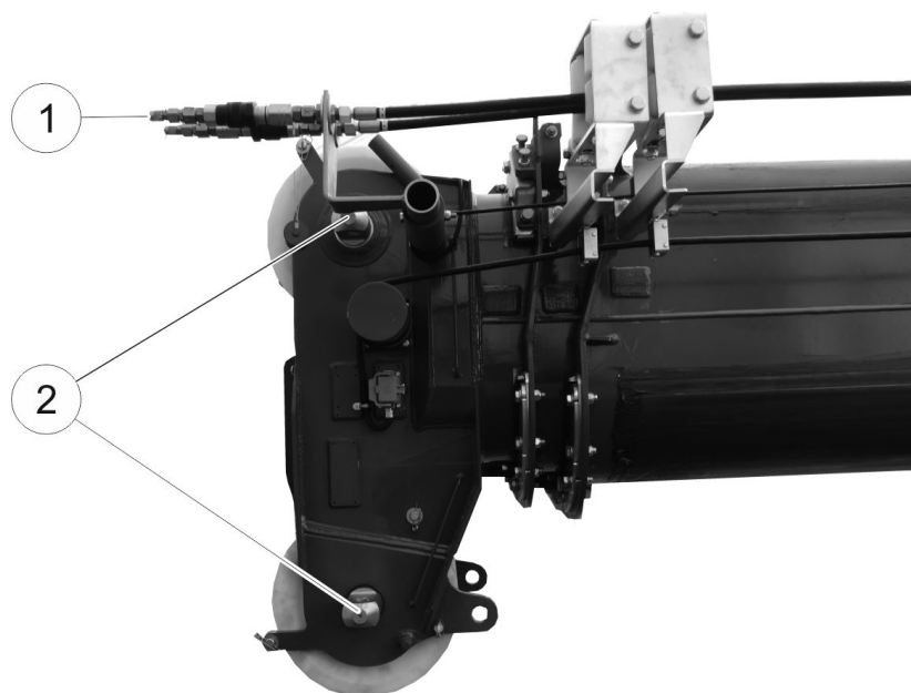
Fig. 143 Conexões dos pinças de fixação na cabeça da lança
