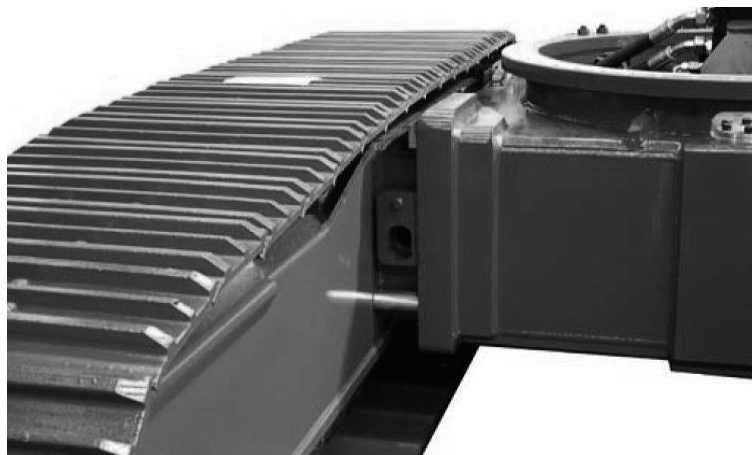
Fig. 119 Estrutura inferior com parafusos removidos (A)
