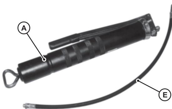
Fig. 236 Pistola de graxa (A) com mangueira de conexão (E)
