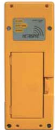
Imagem 3 Carregador HETRONIC com bateria de 9,6 V
