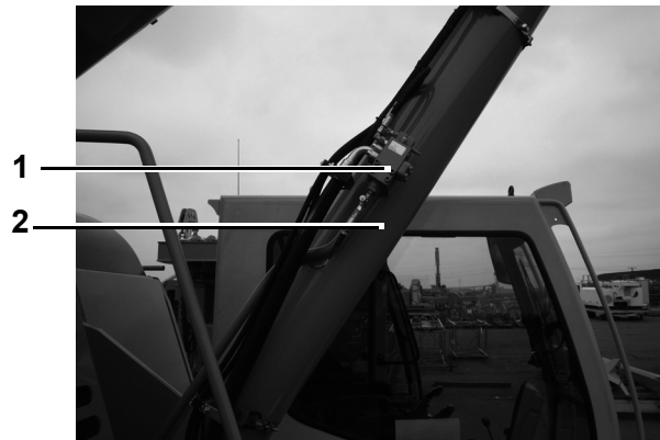
Fig. 84 Sensor de pressão (1) sobre o cilindro oscilante (2)
