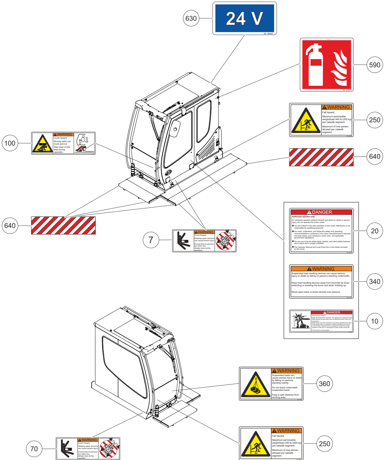
Fig. 5 Sinalização da cabine
