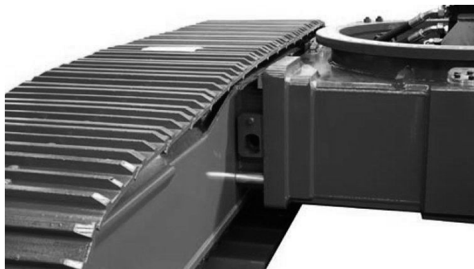
Fig. 115 Estrutura inferior com parafuso removido
